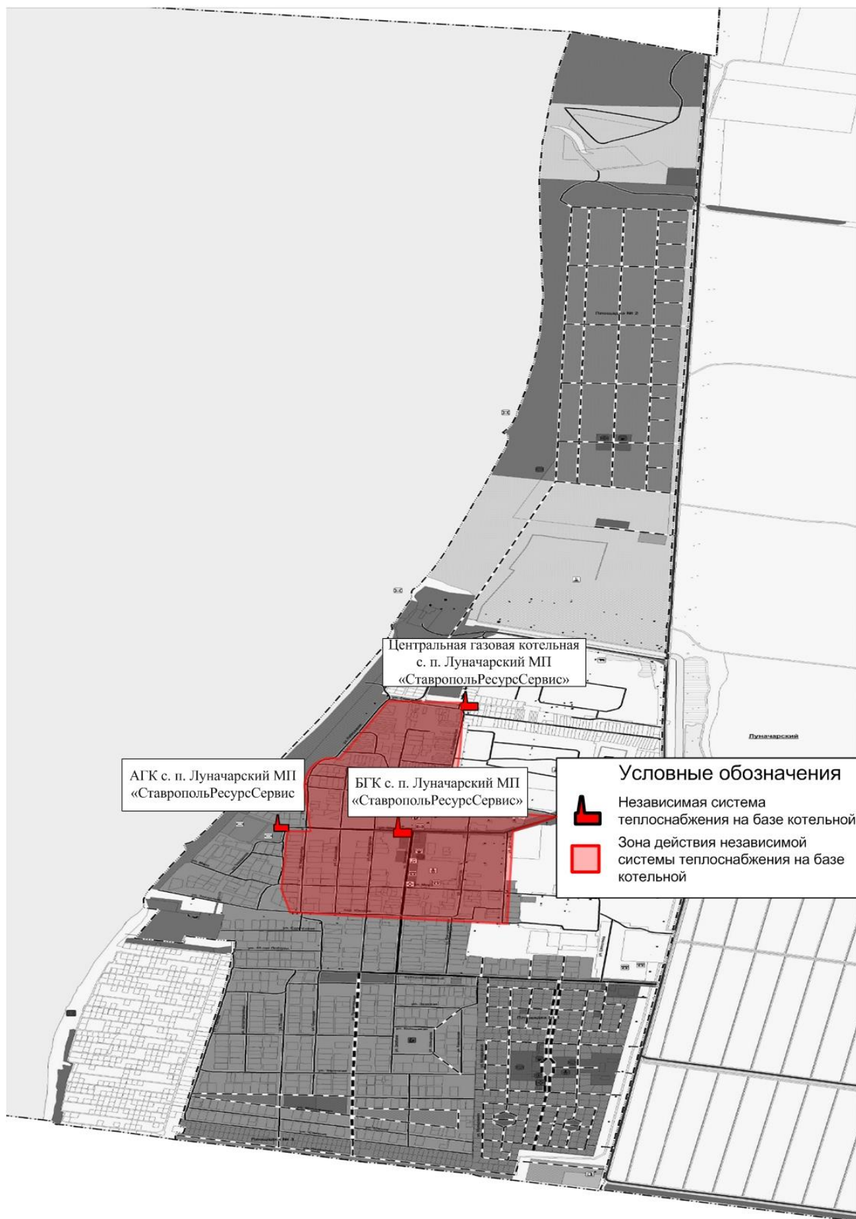
Рис. №1.4.1 - Зоны действия независимых систем теплоснабжения на базе локальных котельной на территории с. п. Луначарский
